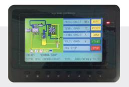
Для управления и контроля работы компрессор оснащен многофункциональным промышленным микропроцессорным блоком управления – контроллером.
