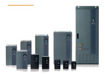
Компания BERG по желанию заказчика производит установку преобразователей частоты. Преобразователь частоты (ПЧ) представляет собой электронный блок управления, который изменяет частоту тока, регулируя скорость вращения ротора электродвигателя, в соответствии с текущим режимом потребления сжатого воздуха. Применение ПЧ позволяет получить значительную экономию энергии.
